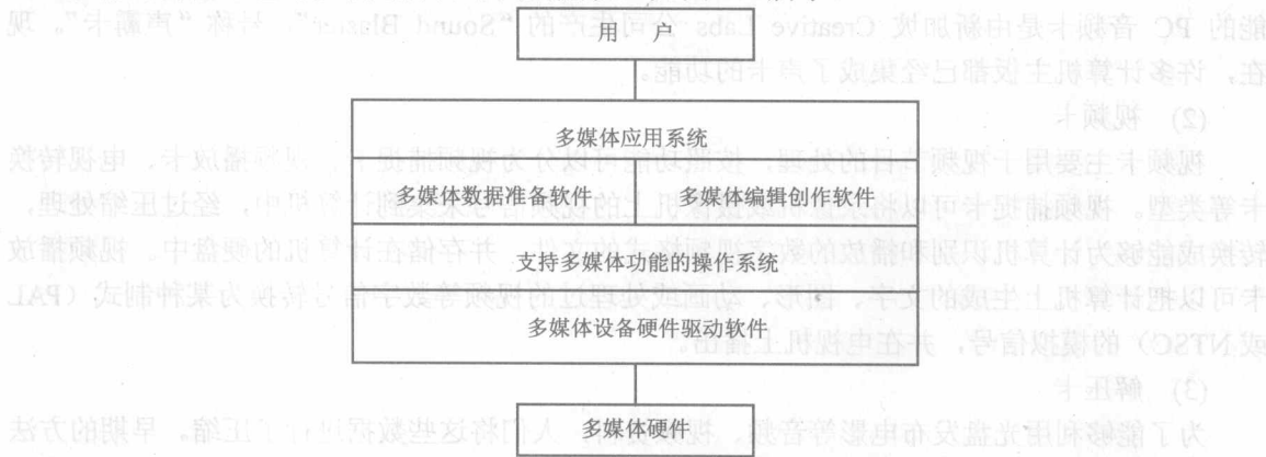
图 1-2 多媒体软件系统的层次结构
