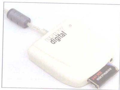
图1.6 将存储卡插入读卡器
