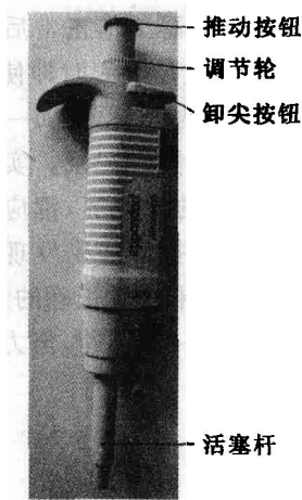
图 1-2 可调式微量移液器的结构
