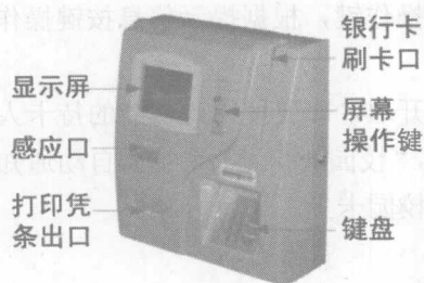
图 1-4 自助转帐机结构
