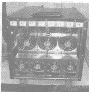
(b) Typhoon PSC 利于散热、降噪的背面设计
