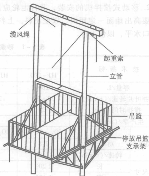
图 1-3 钢管式龙门架
