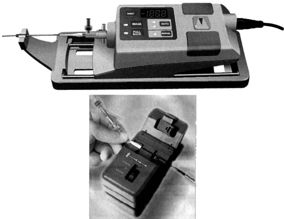
图 1-10 VOLCANO IVUS 自动回撤装置 (引自 VOLCANO 官方网站 http://www.volcanocorp.com )
