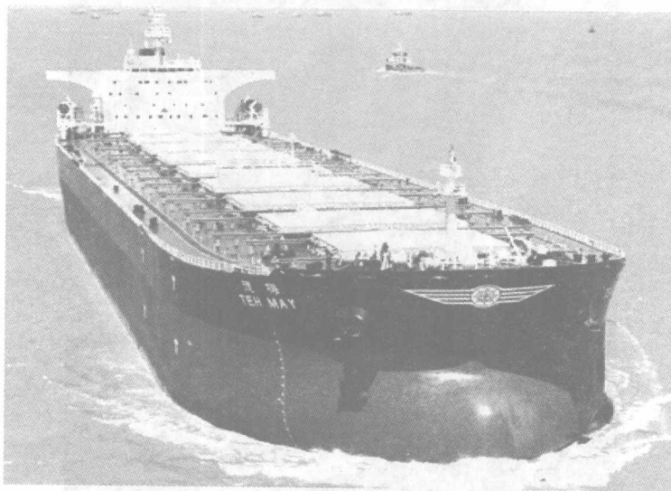
图 1-1-3 好望角散货船图
