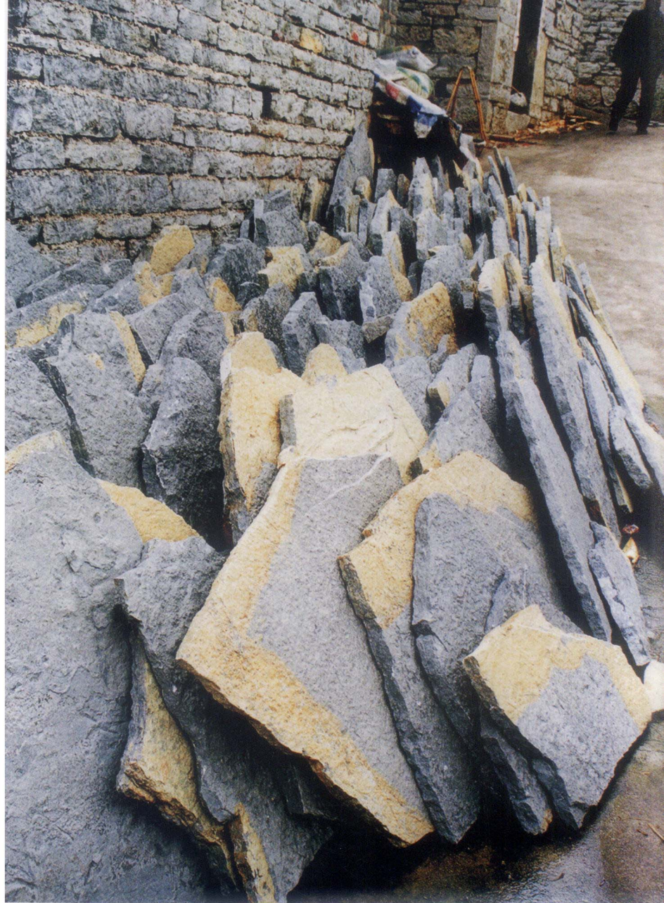
用于石板房顶盖的天然石片材料，厚约3~4厘米。
