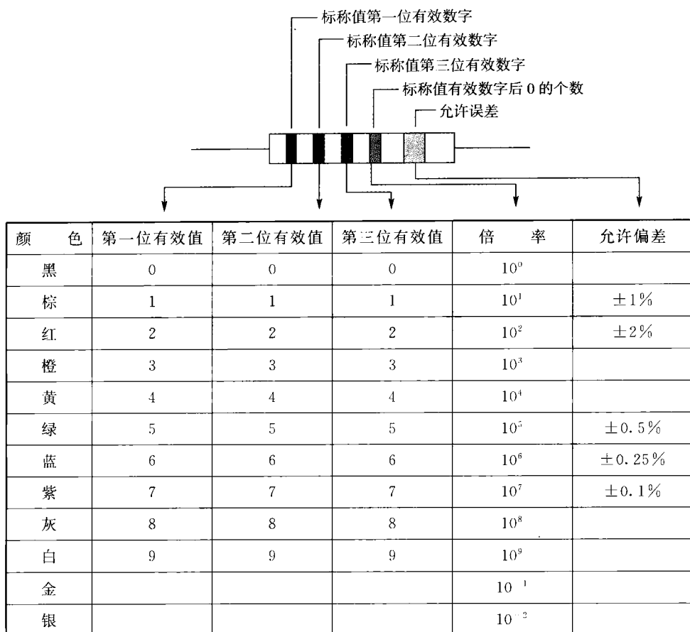
图 1-9 三位有效数字阻值的色环表示法
