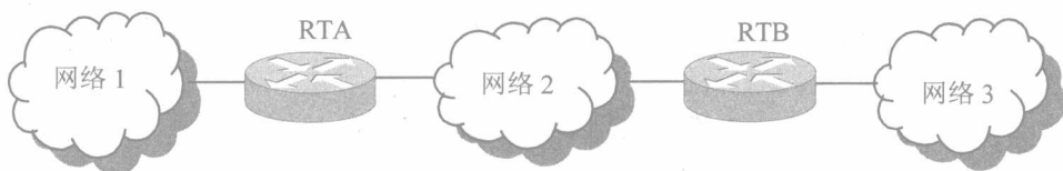
图 1-3 使用两个路由器互联的三个网络
