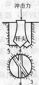
图 1-1 冲击式凿岩原理
