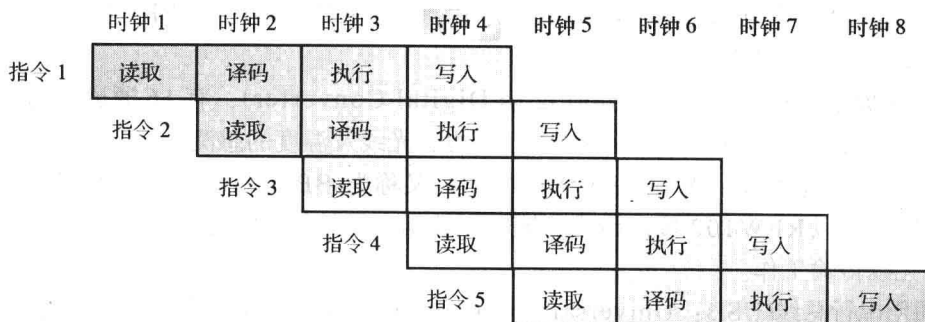
图 1-3 指令流水线(Pipe Line)操作
