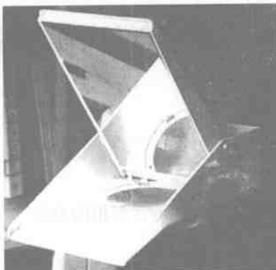
图 1.11 投影器的反射镜和放映镜
