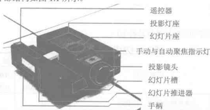
图 1.1 幻灯机的外部结构
