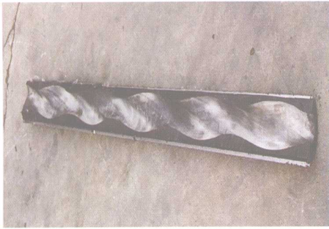
图 1-3 结垢螺杆泵定子
