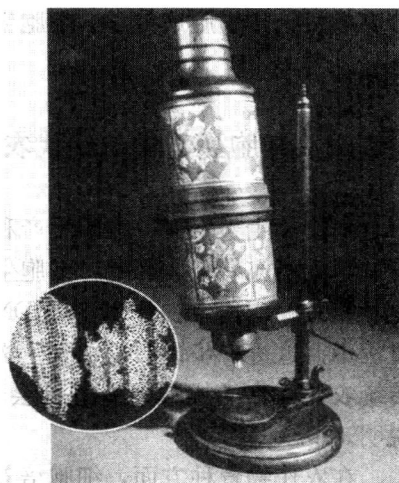
图 1-1 胡克使用的显微镜和软木切片(示蜂窝样结构) (引自 G. Karp, 1996)
