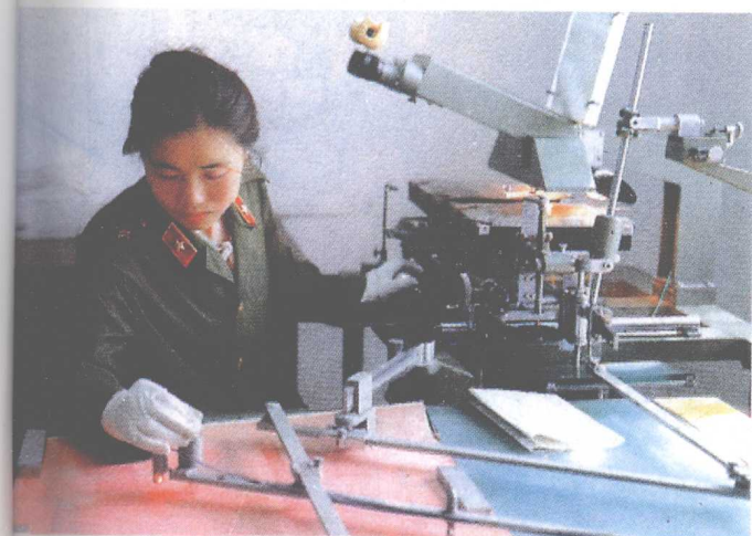
彩图 Ⅲ(I)19 总参测绘局航测内 业人员在X-3视差测图仪上测图
