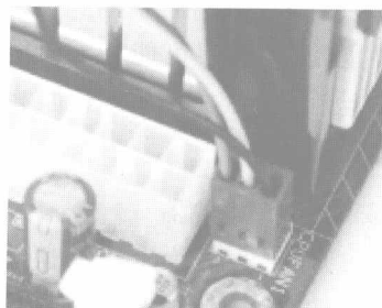
图 1.12 连接散热器电源线
