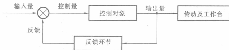
图 1.3 半闭环控制系统框图
