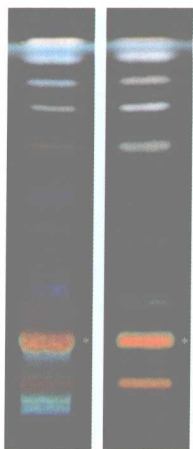
图1 左: 未经 C-18 小柱的白头翁样品; 右: 经过 C-18 小柱的白头翁样品。(*: 白头翁皂苷 C)
