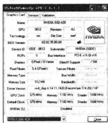
GPU-Z 0.0.1.7识别出的GeForce 9800 GTX信息。核心为G92-420。新版GeForce 8800 GTS的核心为G92-400。
