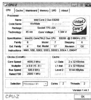
我们在1.4V左右的电压下将Core 2 Duo E8200超频至4GHz
