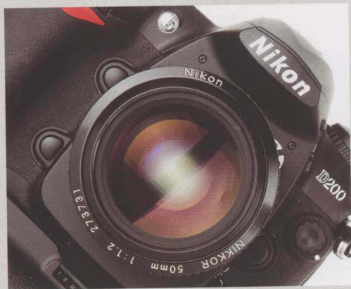
大光圈镜头的优势在于漂亮的散景、快门优势与有利于微弱现场光的拍摄，缺点是笨重与价格高昂
