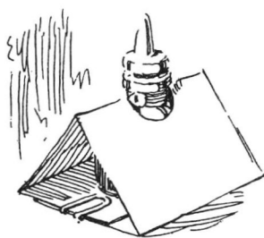
圖19 活動性墨水瓶固定座可由厚紙板和迴紋針製成。
