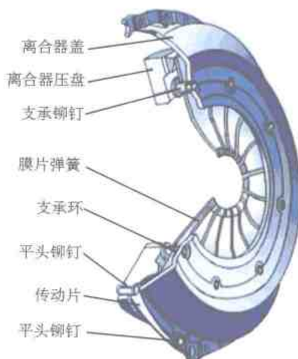
图 1-10 离合器盖和压盘总成的结构形式
