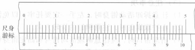
图 1-15 0.02mm 游标卡尺的刻线原理
