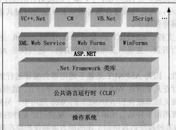
图 1.1 .NET Framework 体系结构
