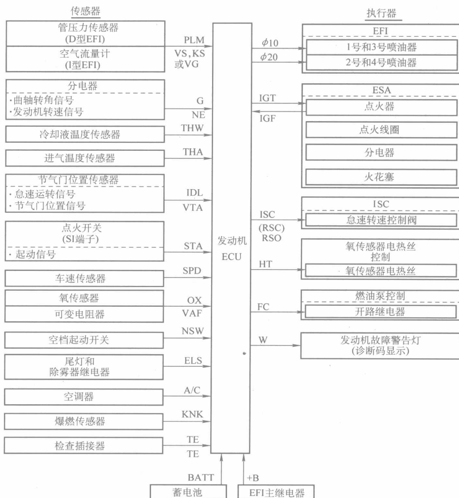
图 1-9 电子燃油喷射发动机电控系统的组成
