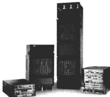
从结构上分，路由器可分为模块化结构与非模块化结构。通常情况下，中高端路由器均为模块化结构，可以使用各种类型的模块灵活配置路由器，增加端口的数量、提供丰富的端口类型，以适应企业不断变化的业务需求。如图所示为 Cisco 3640 模块化路由器。
