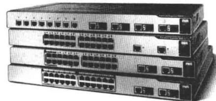
汇聚层交换机（也称骨干交换机或部门交换机）是面向楼宇或部门接入的交换机，用于将接入层交换机连接在一起，并实现与核心交换机的连接。汇聚层可以是固定配置，也可以是模块配置，一般有光纤接口。与接入层交换机相比，汇聚层交换机通常全部采用 1000Mbit/s 端口或插槽，拥有网络管理的功能，可以通过计算机的串口直接连接，或者通过网络远程连接，实现对交换机的配置、监控和测试。支持基于端口的 VLAN，可实现端口管理，对流量进行控制。
