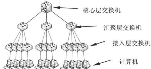
接入层交换机（也称工作组交换机）通常为固定配置，拥有 24~52 口的 100Base-TX 以太网口，用于实现普通计算机的网络接入。同时，往往拥有 2~4 个 1000Mbit/s 端口或插槽，用于实现与汇聚层交换机的连接。接入层交换机一般没有网络管理的功能。如图所示为 Cisco Catalyst 500 Express 系列接入层交换机。
