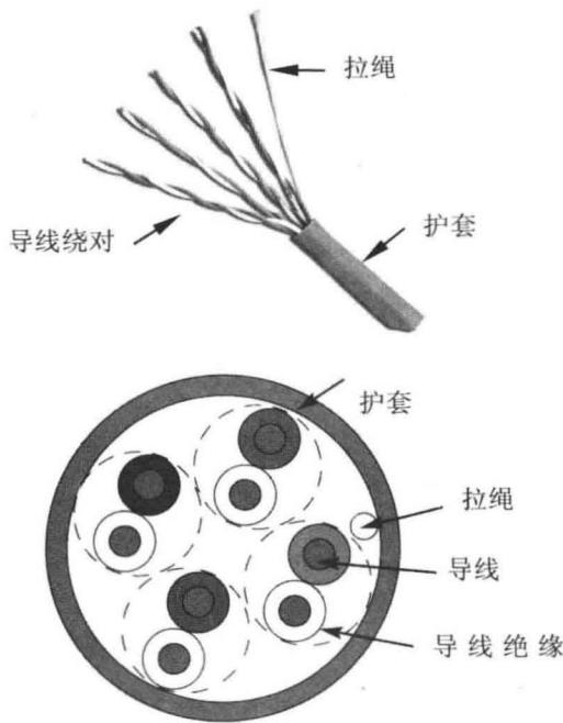
六类（Category 6）非屏蔽双绞线在外形和结构上与超五类双绞线区别较大，不仅增加了绝缘的十字骨架，将双绞线的 4 对线分别置于十字骨架的 4 个凹槽内，而且电缆的直径也更粗。电缆中央的十字骨架的角度随长度的变化旋转，它的作用主要是保持 4 对双绞线的相对位置，提高电缆的平衡特性和串扰衰减。另外，保证在安装过程中电缆的平衡结构不遭到破坏。六类非屏蔽双绞线裸铜线直径为 0.57mm（线规为 23AWG），
