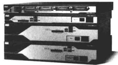
Cisco 7200/7600 系列属中端路由器，是一款高度可扩展的多用途系统，能够为企业总部应用提供可靠的第 2 层和第 3 层服务。如图所示为 Cisco 7600 系列路由器。
