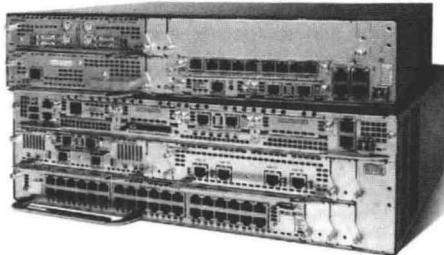
低端路由器则多为非模块化结构，只能提供固定类型和数量的端口。如图所示为应用于 SOHO 的 Cisco SOHO 96 固定配置路由器。
