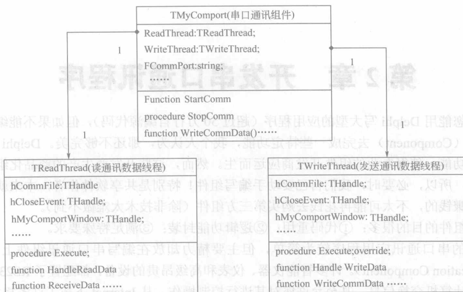
图 2-1 通讯组件的 UML 类图及关联
