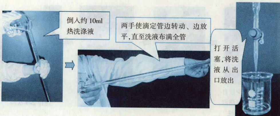
图 1-10 酸式滴定管润洗方法
