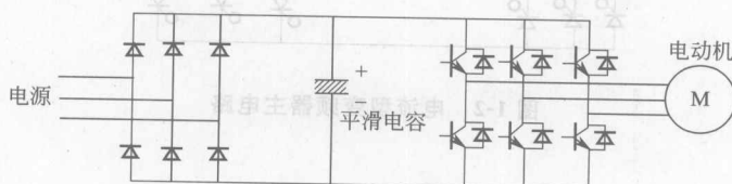
图 1-1 电压型变频器主电路
