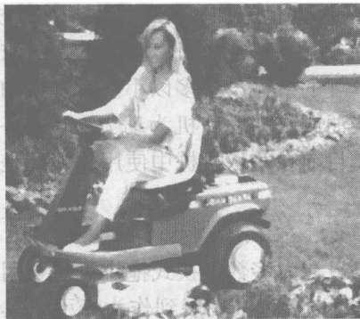
图 1-3 旋刀式割草机挂接在动力设备的中部
