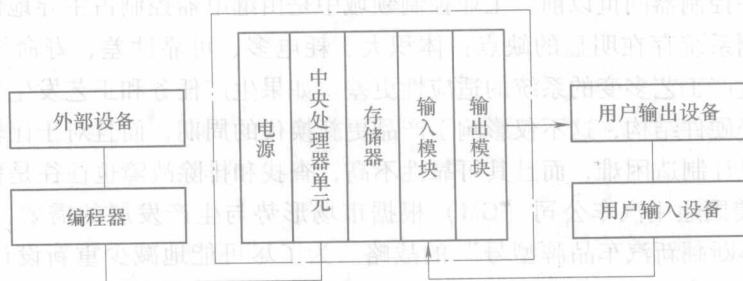
图 1-1 PLC 控制系统结构简图
