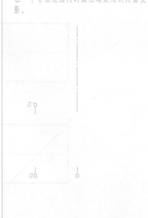
6. 已知中空的平螺旋面外侧大圆柱螺旋线与第5题相同,内侧小圆柱螺旋线的直径为16 mm,求作从点A向上的一个导程内的平螺旋面的两面投影。
