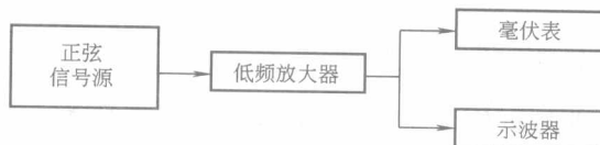
图 2-2 低频放大器特性测试电路示意图
