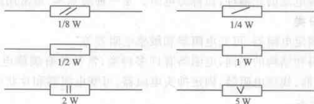
图 1-3 电阻器标有额定功率的电路符号
