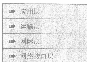
图 1-5 TCP/IP 协议组可以概念化为四层的通信体系结构
