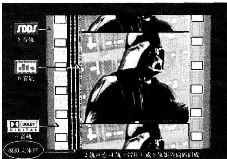
图 1-4 Dolby SR.D、DTS 和 SDDS 系统数字、模拟声迹位置
