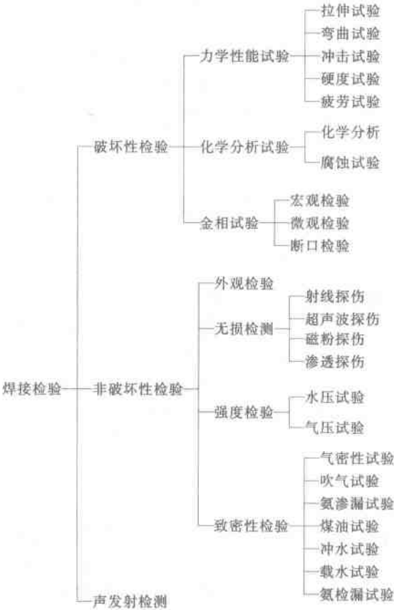
图 1-1 主要焊接检验方法
