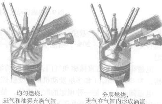
图 11 GDI 发动机的两种燃烧方式
