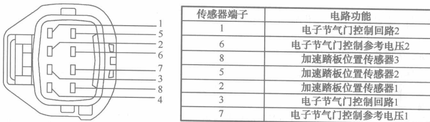
图 1-1-4 加速踏板位置传感器端子识别
