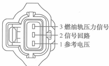
图 1-2-2 燃油轨压力传感器端子识别
