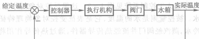
图 1-4 水温自动控制系统结构图
