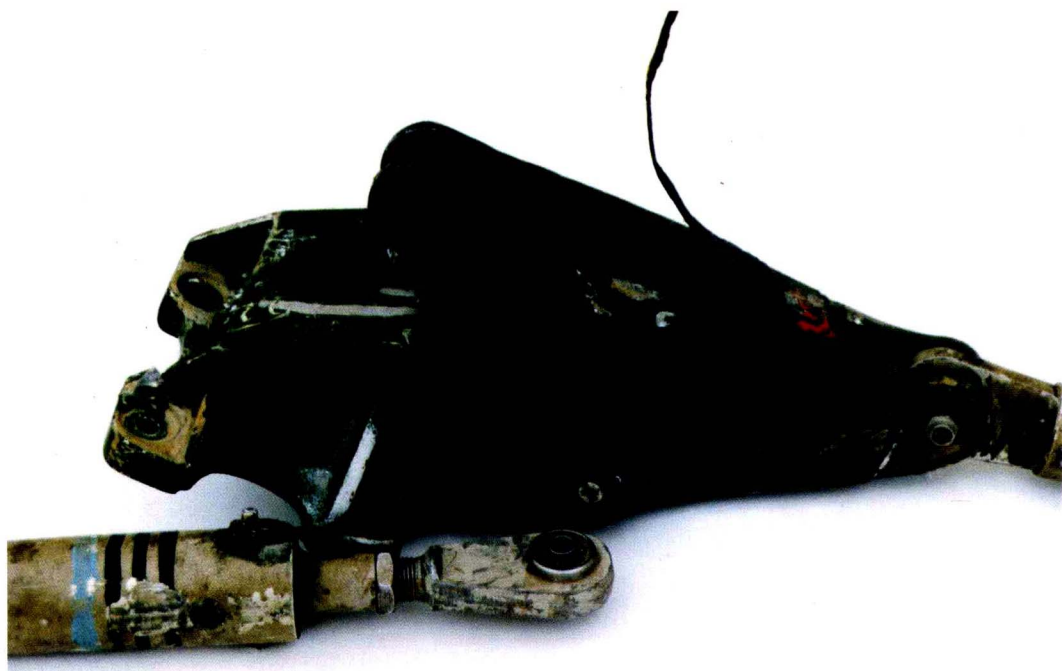
1999年2月24日 Tu-154 飞机在浙江温州发生的空难中的关键失效件
