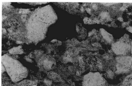
粒间孔, 单偏光 10 \times 20 牛35井, 2957m
