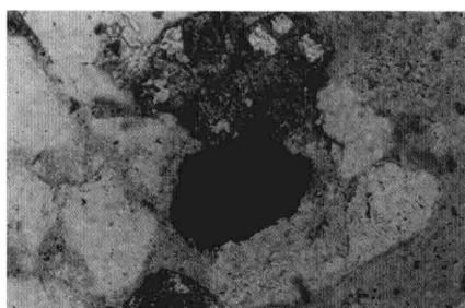
铁白云石溶蚀成孔隙, 单偏光 10 \times 20 河125-1井, 3018.5m
