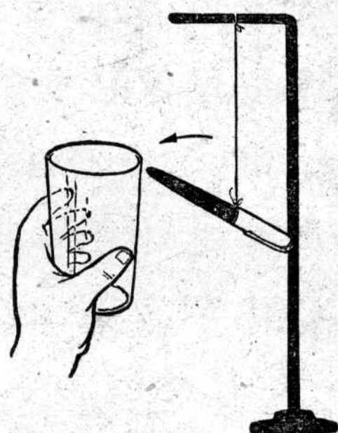
带正电的玻璃杯靠近带负电的自来水笔，它们吸在一起——异性相吸
