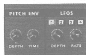
“PITCH ENV”为音高包络调节，“DEPTH”调节包络的深度，“TIME”调节包络时间。“LFOS”为低频振荡器，下面的1、2、3、4分别代表4种模式供我们选择，“DEPTH”为调节低频振荡器的深度，“RATE”为调节低频振荡器的速率。
