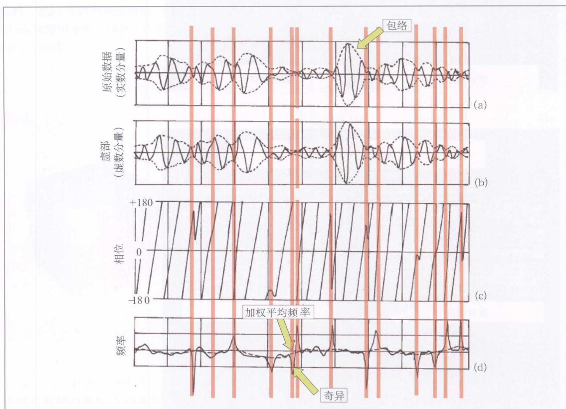
图 1.9 复数道属性包括实数道、虚数道、包络、瞬时相位和瞬时频率。波形干涉在瞬时相位产生奇异性，如最低箭头所指示的负的偏差。按包络衡量瞬时频率的权值，通过在整个短时窗作加权平均频率计算并作平滑，可以压制这类偏差（据 Taner 等，1979）
