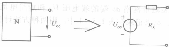
图 1.3-1 二端网络的戴维南等效电压图
