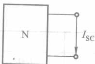
图 1.3-3 求解戴维南等效电阻方法图
