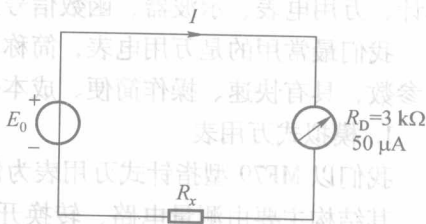
图 1.1-3 电阻测量原理图
