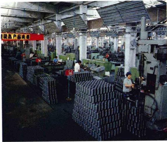
西安内燃机配件厂的汽缸套生产车间
