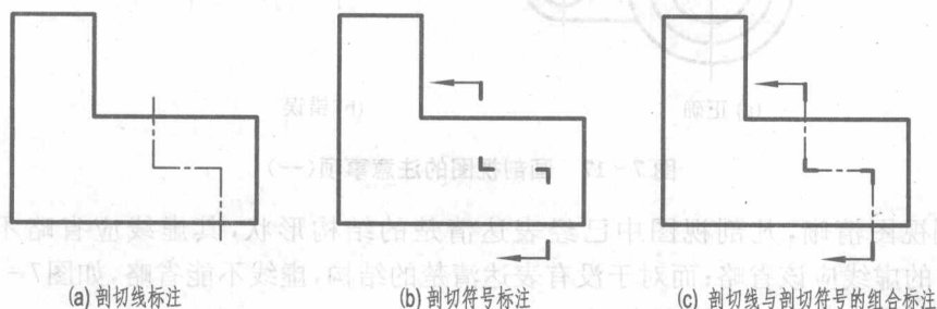
图 7-14 剖切符号和剖切线的标注
